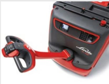
El bajo punto de anclaje del timón garantiza una amplia distancia de seguridad entre el operario y el chasis.
