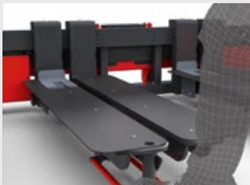
Dispositivo de desbloqueo de horquillas con un mecanismo ergonómico de expulsión de horquillas en el modelo LT-C
