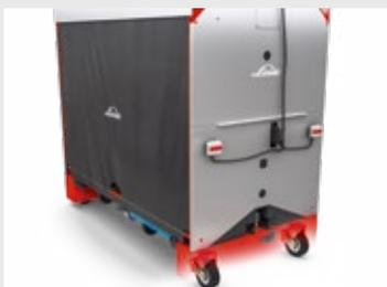
Kit de seguridad opcional: protección intemperie, ruedas SE con suspensión, luz giratoria y luces traseras
