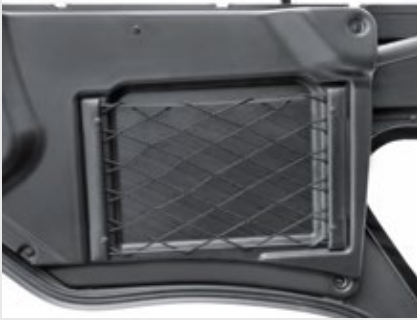
Malla de almacenaje en la puerta
