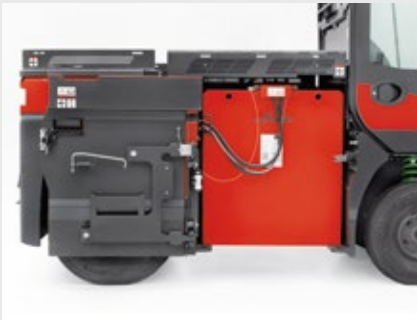
Cambio de batería lateral
