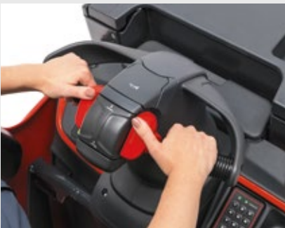
Manillar ergonómico de altura ajustable
