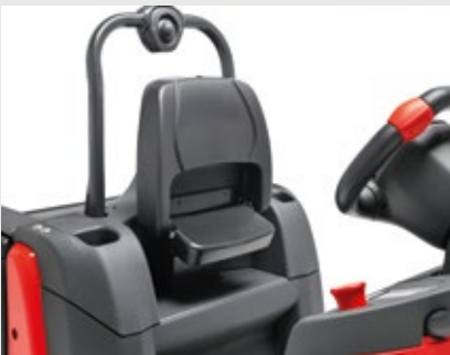
Respaldo ajustable en altura con soporte de asiento plegable
