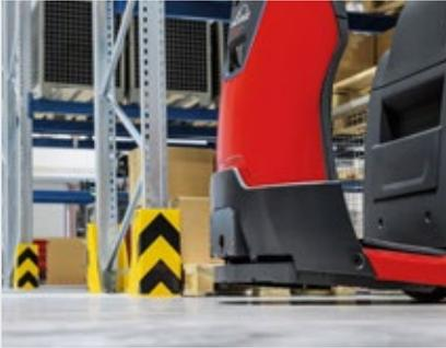
Linde BlueSpot™ y parachoques con escáner de seguridad incorporado
