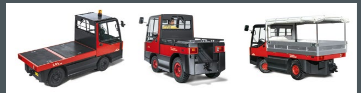
El W20 y el P250 con plataforma de carga y escotadura trasera para una visibilidad despejada del sistema de enganche, y el W20 con un toldo flexible y paneles laterales abatibles.
