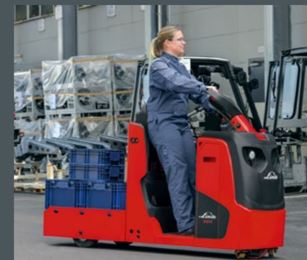
Modo de conducción de conductor incorporado
