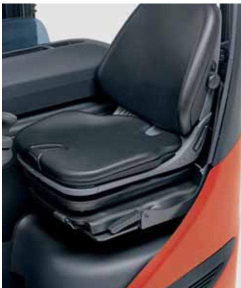
La suspensión neumática del asiento se ajusta automáticamente para adaptarse al peso individual del operario
