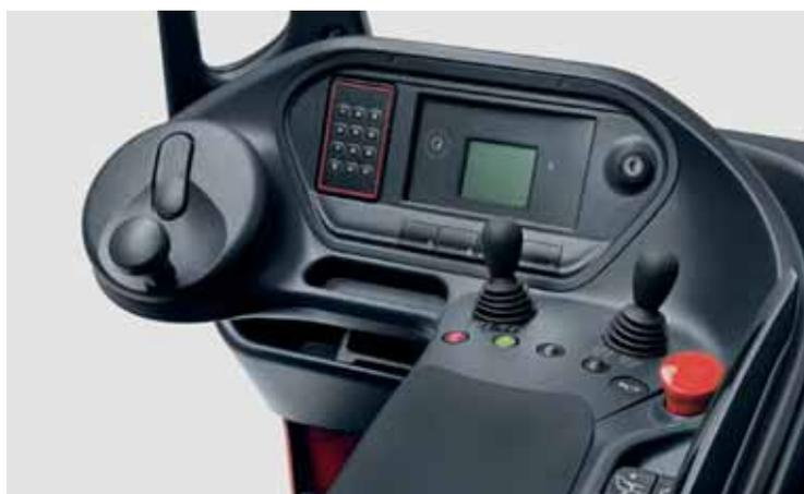
Control **sensible y preciso** de funciones del mástil **con la punta de los dedos** mediante palanca de mando
