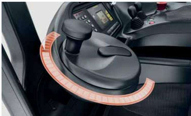
Con el sistema de dirección eléctrico reológico de Linde, que incorpora información sobre el par motor y número de vueltas de volante **entre topes ajustables**. La nueva gama constituye una solución ideal para la manipulación de cargas en pasillos estrechos
