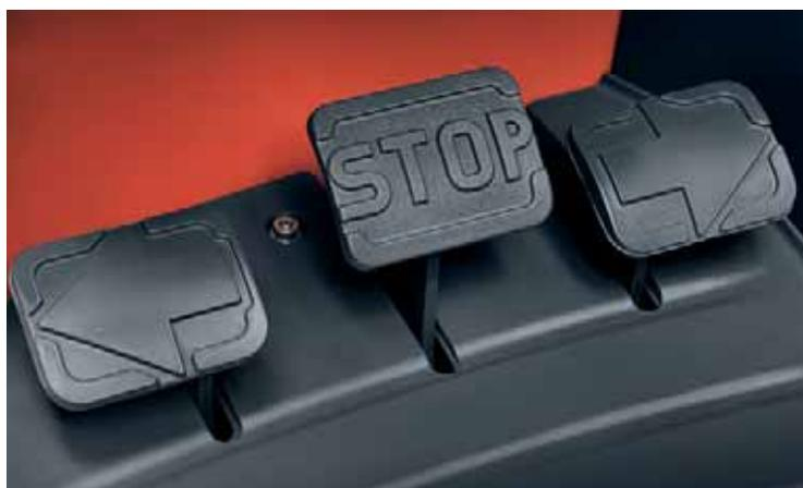
El formato de los pedales de aceleración **dobles de Linde** permite cambiar de dirección sin solución de continuidad y sin cambiar de pie
