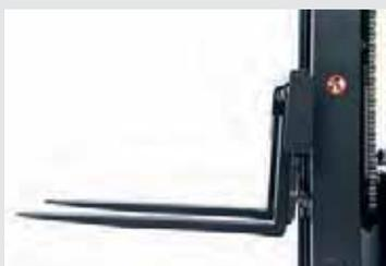
Al inclinar el portahorquillas hacia adelante o hacia atrás, el mástil fijo se mantiene estable
