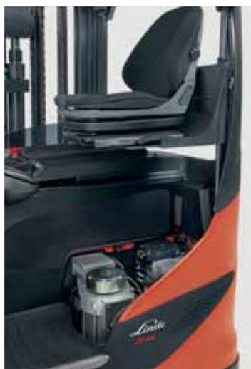
Asiento del operario **montado sobre pivote** para mejorar el acceso durante el mantenimiento
