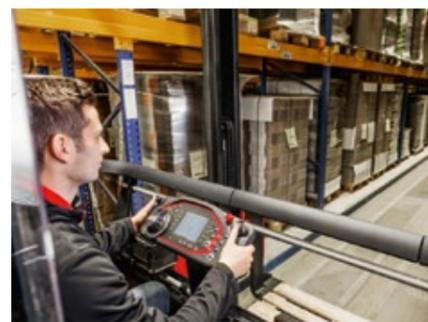
**El panel de mandos frontal** puede ajustarse fácilmente en altura, inclinación y ángulo según las preferencias del operario. La pantalla totalmente gráfica muestra todos los datos importantes de la carretilla, tales como la hora, la altura de elevación actual, la velocidad de traslación, el peso de la carga y el nivel de carga de la batería.
