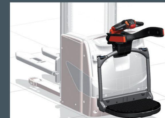
La plataforma, las protecciones laterales y el timón forman una única estructura que está completamente suspendida y aislada del chasis mediante 4 puntos de unión. Esta configuración reduce al mínimo las vibraciones sentidas por el operario y mejora el confort durante su jornada laboral. Este diseño innovador también garantiza una larga vida útil del propio apilador.
