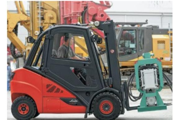
Empleando de serie un sistema electrónico de amortiguación de posición final, se evitan impactos bruscos cuando los cilindros de inclinación se aproximan a su posición final.
