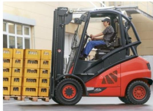
Carretilla Linde en su versión para la industria de las bebidas. El conductor tiene en todo momento una buena visión desde la **cabina alzada**, incluso al apilar cargas a gran altura en la horquilla.
