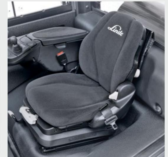
Además de las cubiertas textiles resistentes a la abrasión, el **asiento confort**, recubierto de carbón activo, ofrece un apoyo mecánico a la región lumbar y suspensión neumática adicional.
