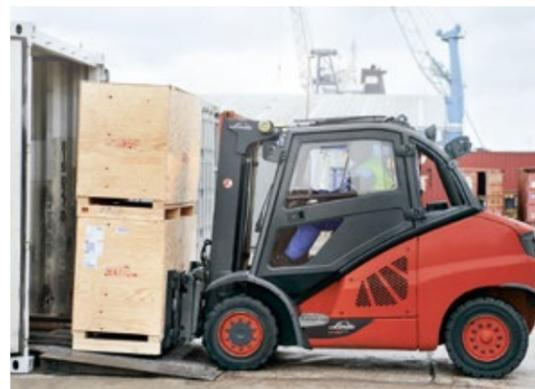
**Ideal para entradas bajas.** Incluso para las potentes carretillas de 5 toneladas, Linde ofrece una versión con una altura de sólo 2,22 m.
