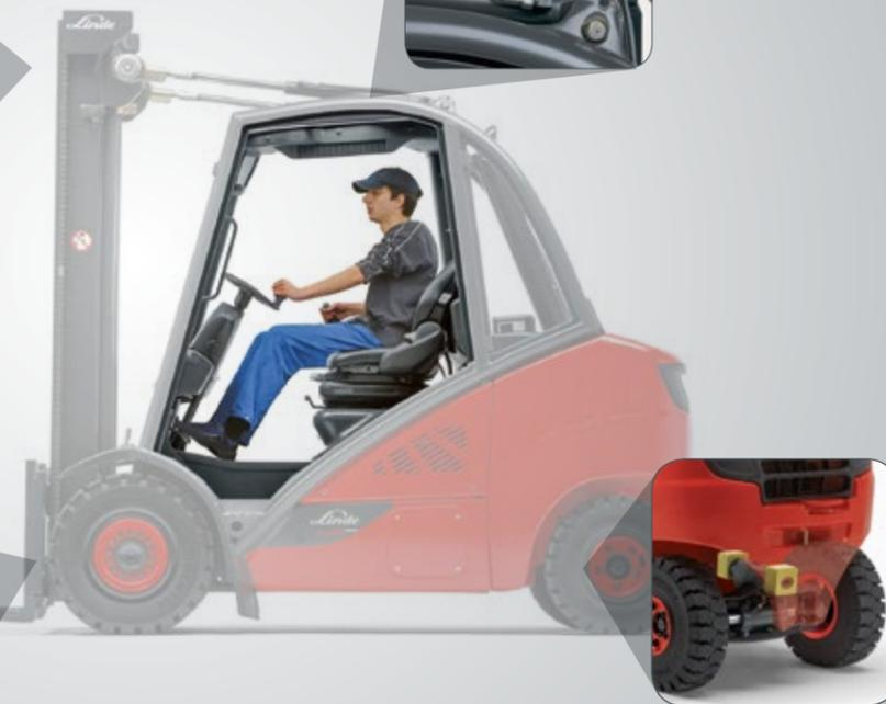
Los rodamientos especiales del eje de dirección reducen los impactos y vibraciones causados por superficies irregulares
