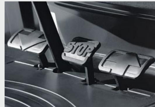
Desplazamiento hacia adelante y hacia atrás sin necesidad de cambiar de sitio los pies gracias al **control mediante doble pedal de Linde**.
