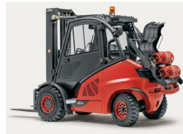
**Cambio de bombona ergonómico** en funcionamiento con gas licuado. No se requiere fuerza adicional por parte del conductor.
