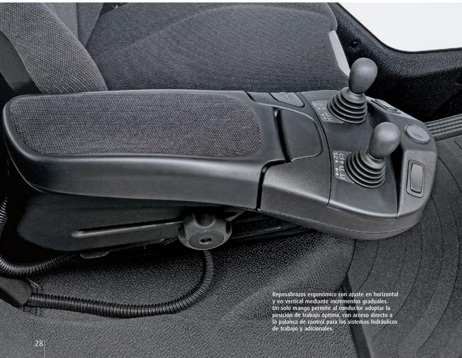
Reposabrazos ergonómico con ajuste en horizontal y en vertical mediante incrementos graduales. Un solo mango permite al conductor adoptar la posición de trabajo óptima, con acceso directo a la palanca de control para los sistemas hidráulicos de trabajo y adicionales.
