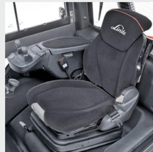
El **asiento súper confort** de Linde, con suspensión neumática de serie, dispone de un sistema de calefacción de asiento y respaldo, extensión del respaldo y ajuste de profundidad y ángulo del cojín
