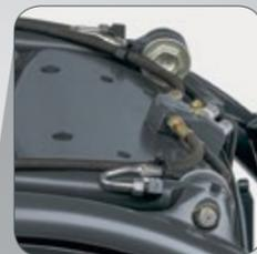
Los rodamientos del cilindro de inclinación, libres de mantenimiento, reducen las paradas y los costes de explotación
