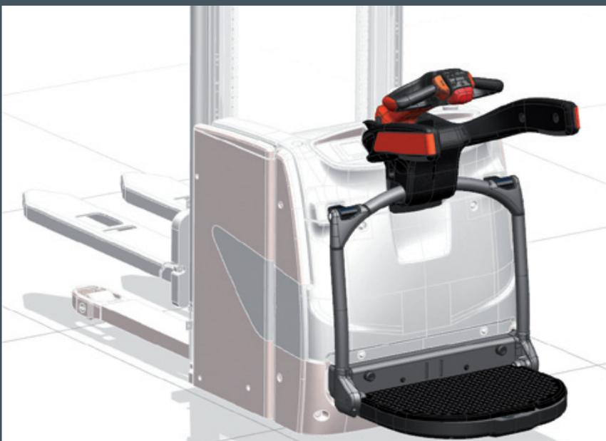
La plataforma, las protecciones laterales y el timón forman una única estructura que está completamente suspendida y aislada del chasis mediante 4 puntos de unión. Esta configuración reduce al mínimo las vibraciones sentidas por el operario y mejora el confort durante su jornada laboral. Este diseño innovador también garantiza una larga vida útil del propio apilador.
